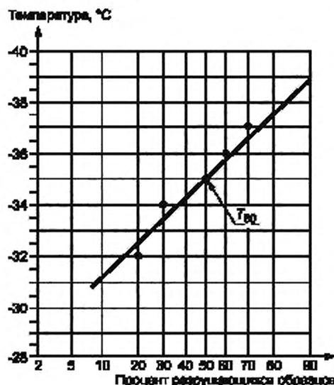
Рисунок 5 — Графический метод определения температуры хрупкости  $T_{50}$
