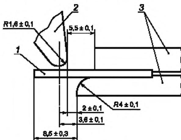
1 — испытываемый образец, 2 — зажимное приспособление; 3 — ударный боек
