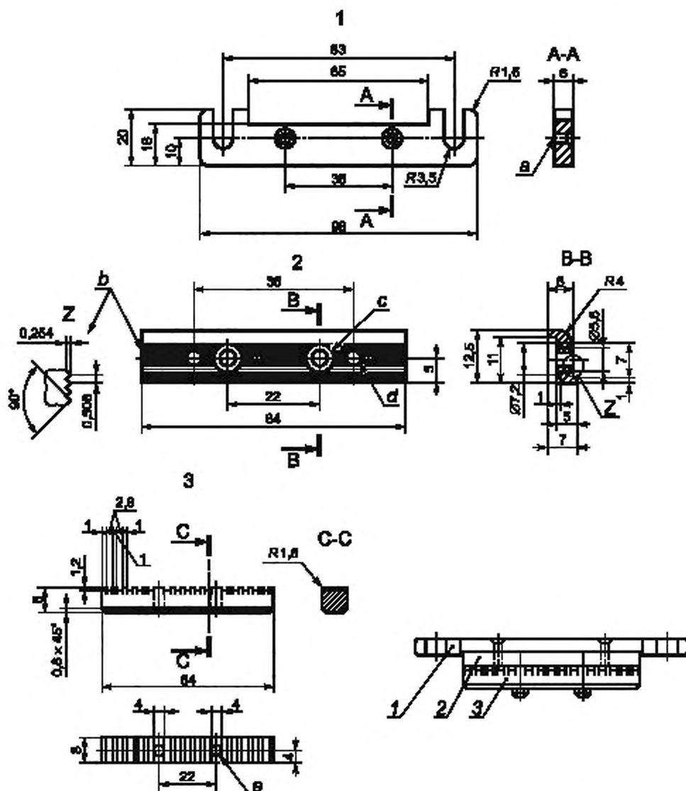
а — два отверстия диаметром 3,7 мм; зенкованные диаметром 6,4 мм, 90°; б — удалить острые углы на зубцах; с — две вставленные втулки; д — два отверстия 48А; е — два отверстия диаметром 3,7 мм
