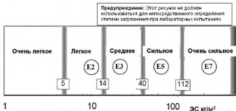
Рисунок 3 — Взаимосвязь между измерениями ЭС типа В и классом СЗ для обоих типов стандартных изоляторов или мониторинга
