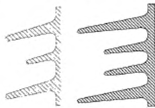
Рисунок 6 — Типичный профиль с переменным вылетом ребра
