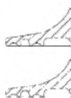
Рисунок 4 — Типичный профиль с мелкими канавками под ребром
