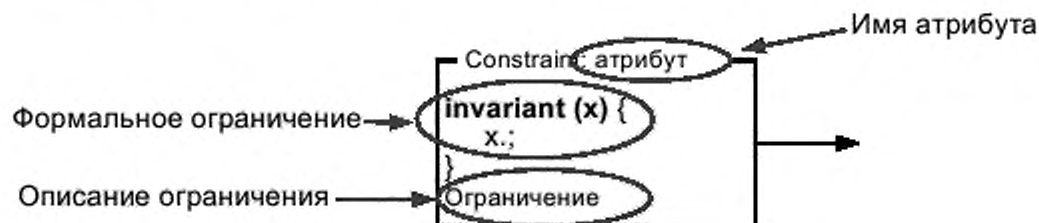
Рисунок G.24 — Обозначение ограничения на диаграмме модели D-MIM
