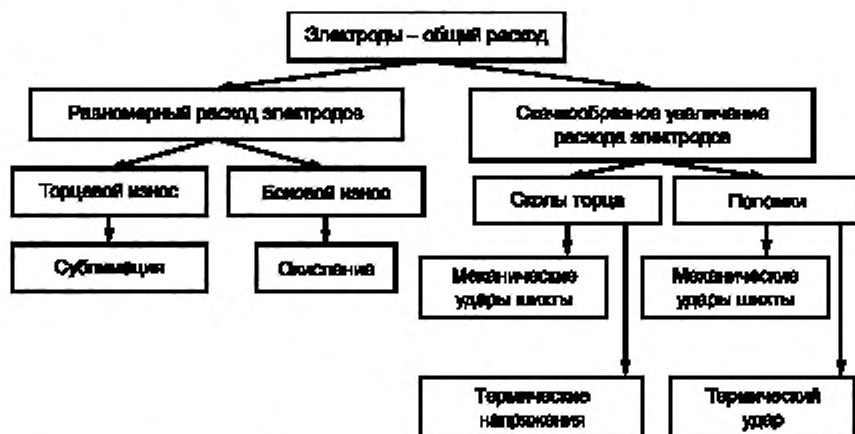
Рисунок 12 — Схема-модель процесса расхода электродов
