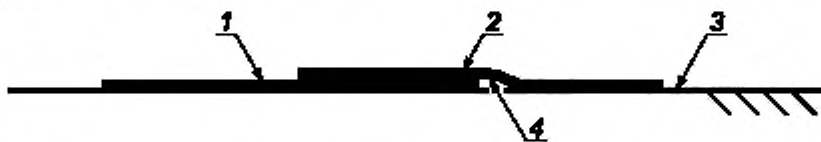
1 — нижний слоистый материал; 2 — верхний слоистый материал, 3 — поверхность технологической оснастки; 4 — изгиб в верхнем слоистом материале для изготовленной методом мокрого формования усиленной волокнами пластмассы (FRP)
