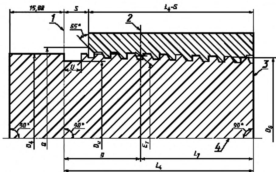
1 — плоскость конца сбега резьбы; 2 — основная плоскость; 3 — плоскость торца трубы; 4 — ось резьбы
