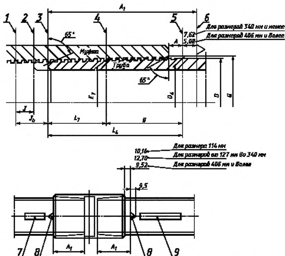
1 — плоскость середины муфты; 2 — торец трубы при механическом свинчивании; 3 — торец трубы при свинчивании от руки; 4 — основная плоскость; 5 — плоскость последней риски на трубе; 6 — плоскость основания треугольного клейма; 7 — цветная полоса размером 25×102 мм, нанесенная у конца трубы со стороны муфты, навинченной на заводе; 8 — треугольное клеймо; 9 — цветная полоса размером 25×610 мм, нанесенная у конца трубы, свинчиваемого с муфтой в промышленных условиях
