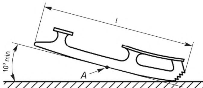
*A* — точка, через которую проводят касательную для измерения угла ( $A = 1/2l$ ); *l* — длина полоза конька
