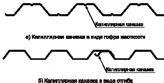
Рисунок 3 — Основные виды капиллярных канавок
