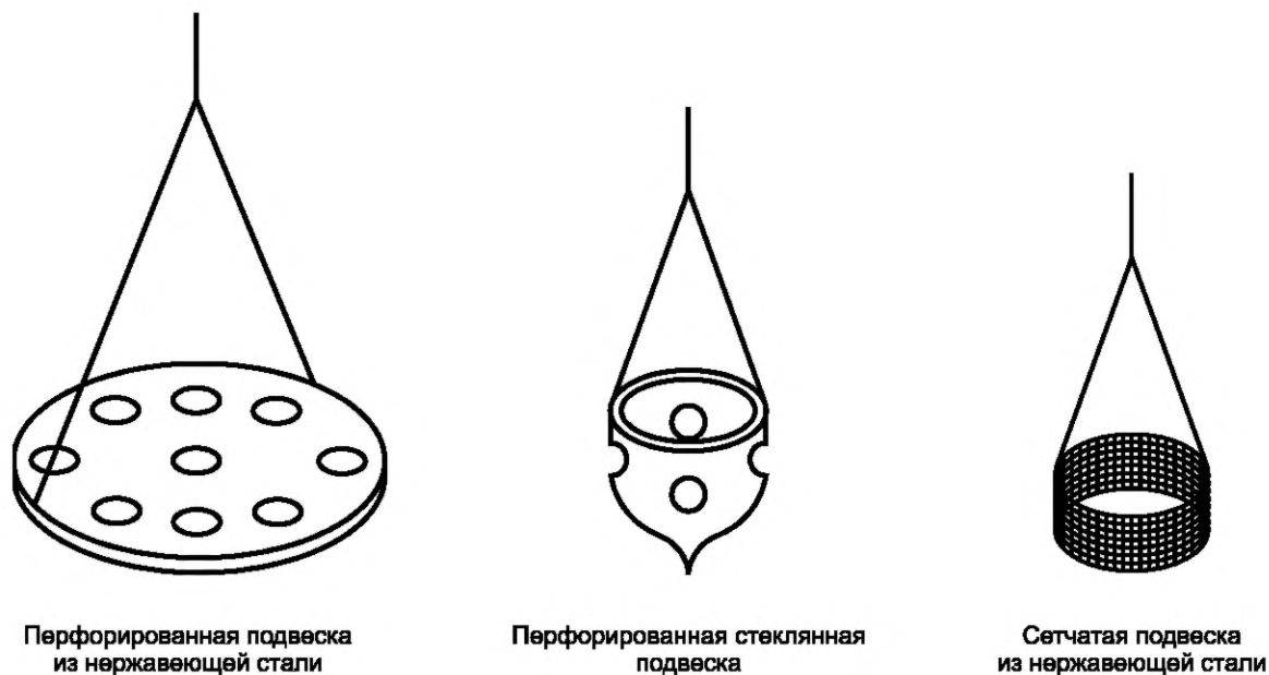
Рисунок 1 — Примеры подставок под испытуемый образец
