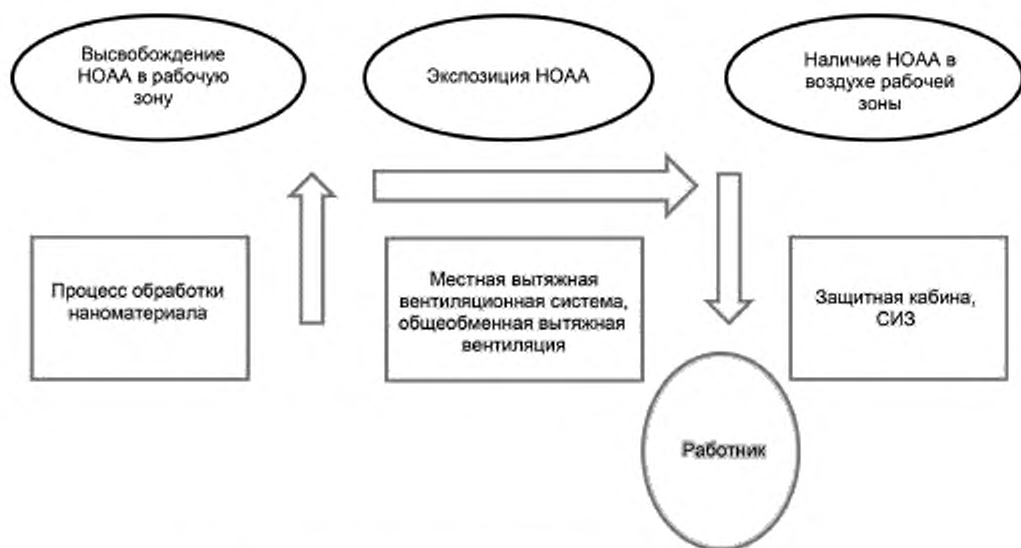
Рисунок 7 — Схема воздействия на опасность при работе с наноматериалом
