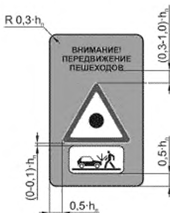
Рисунок В.11 — Пример компоновки изображений знаков стандартной формы, расположенных на фоне щита желтого цвета
