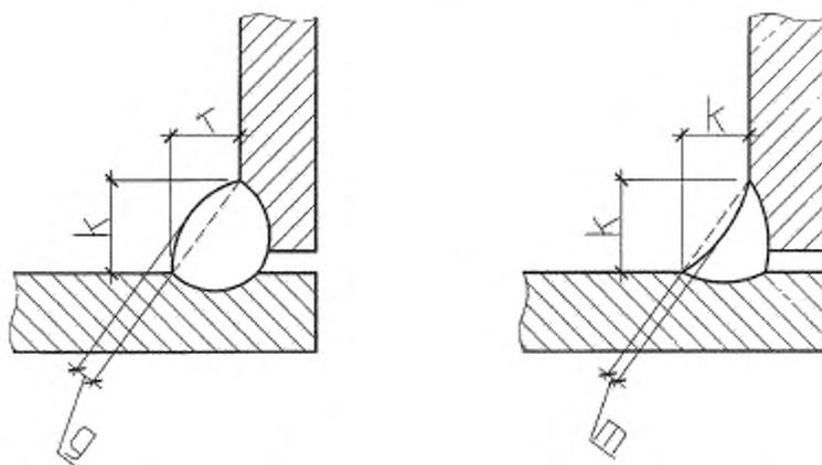
$k$  — катет углового шва;  $g$  — выпуклость углового шва;  $m$  — вогнутость углового шва
