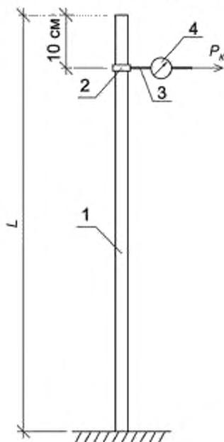
1 — композитная опора; 2 — хомут; 3 — стальной трос,
