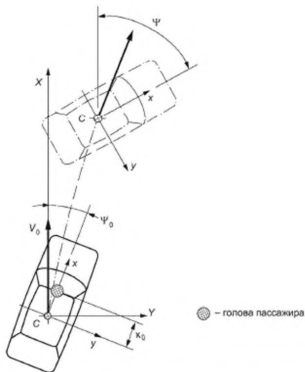
Рисунок Б.5 — Схема для расчета скорости головы в момент удара
