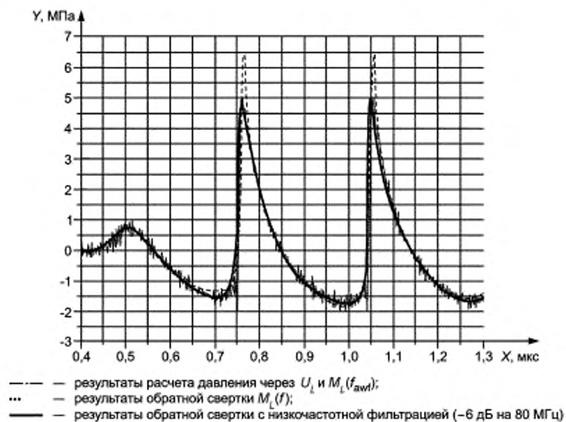
Рисунок D.2 — Результаты обратной свертки волновой формы на примере доплеровского импульса давления, измеренного зондовым гидрофоном
