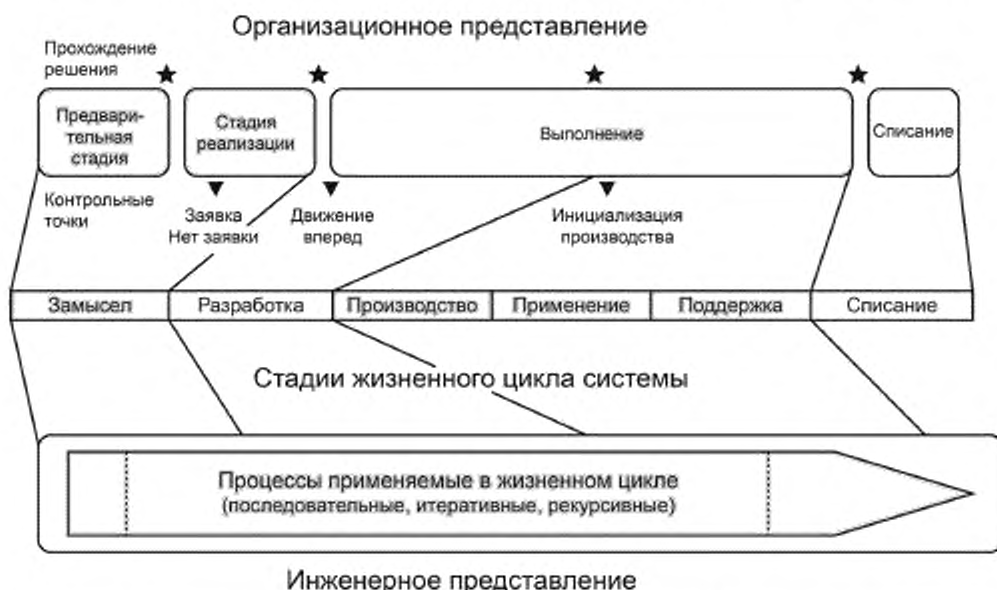
Рисунок 17 — Организационное и инженерное представления, связанные с соответствующей моделью жизненного цикла системы
