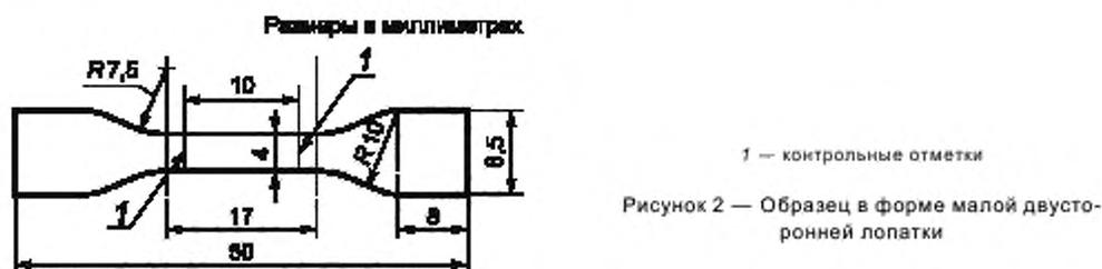
Для секторных жил образцы в виде двусторонних лопаток вырезают со стороны дуги сектора.
