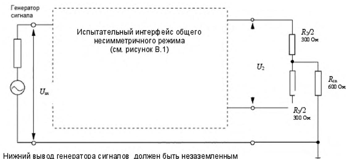
Рисунок В.2 – Схема калибровки для испытательной установки 1
