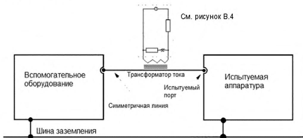
в) Испытательная схема для варианта 2
