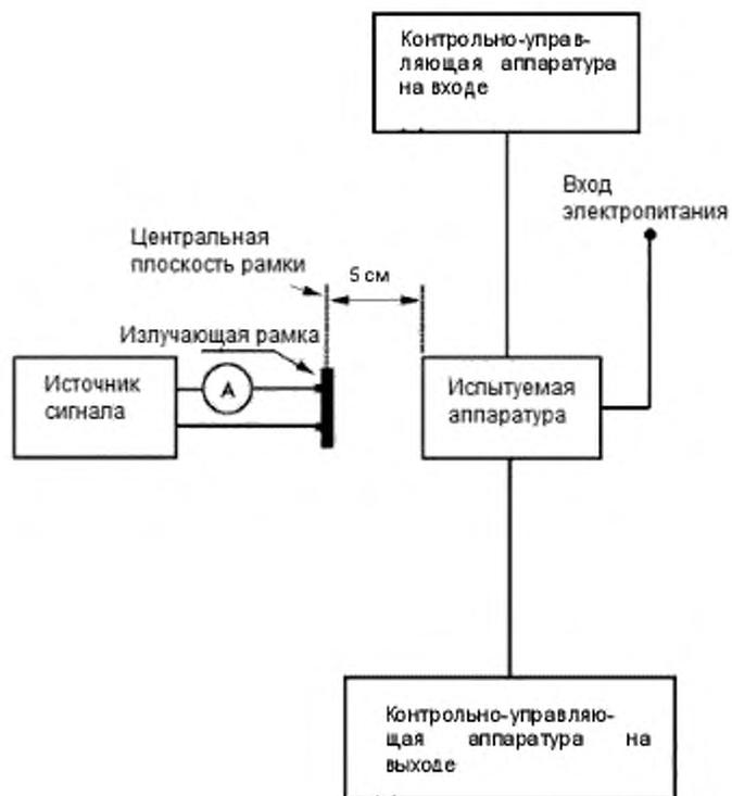
Рисунок А.3 – Типовая установка для испытаний на устойчивость к неоднородному магнитному полю
