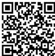
Рисунок А.4 — Символ QR Code с повреждением фиксированных шаблонов
