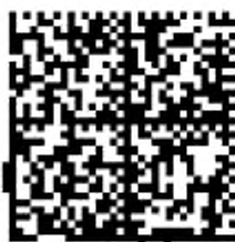
Рисунок А.3 — Тестовый символ для параметра «повреждение фиксированных шаблонов» (Fixed Pattern Damage) (символ Data Matrix)
