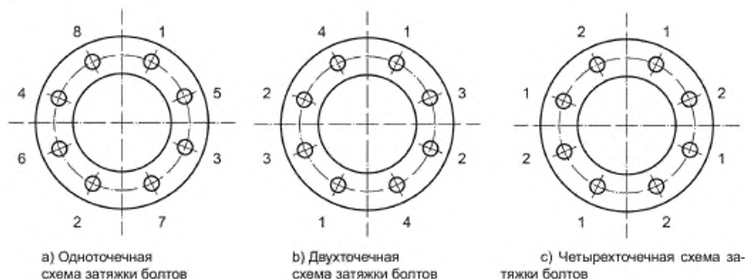
Рисунок G.2 — Перекрестная последовательность затяжки болтов одним, двумя и четырьмя инструментами одновременно
