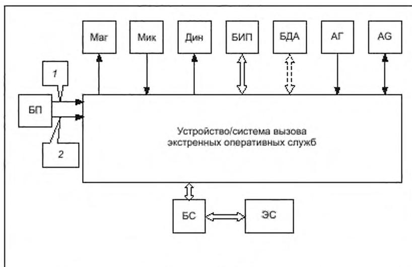
Маг — магнитола АТС; Мик — микрофон; Дин — динамик; БИП — блок интерфейса пользователя; БДА — блок датчика аварии;
