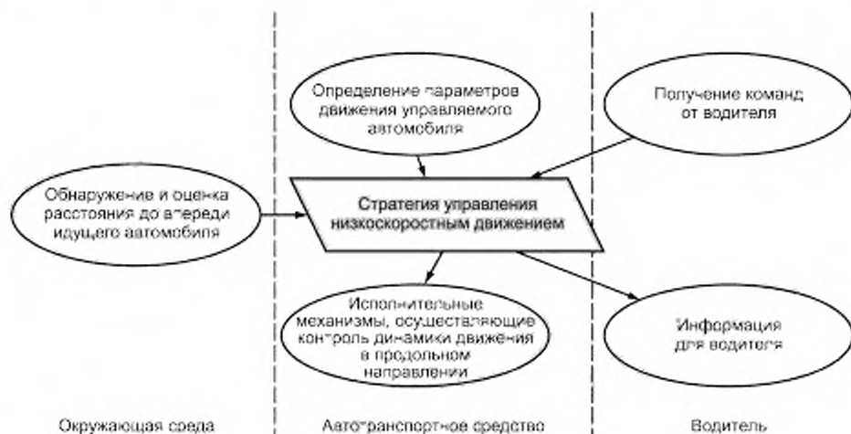
Рисунок 1 — Функциональные элементы системы LSF
