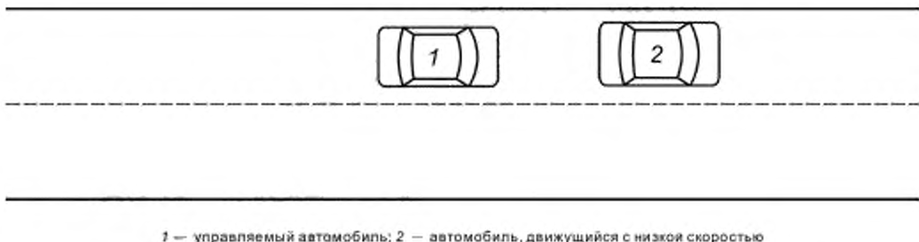
Рисунок 17 — Тестирование способности к автоматической смене траектории движения (конечные условия)
