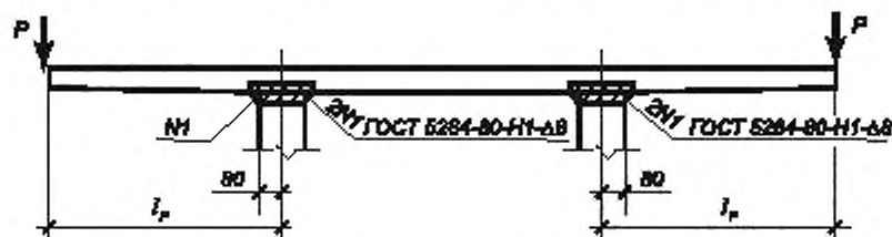
Рисунок 5 — Схема испытания ступеней типоразмера ЛСС 24
