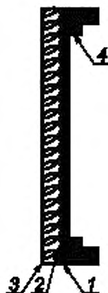
1 — лист стальной или дюралевый; 2 — звукопоглощающий материал; 3 — перфорированный лист или металлическая сетка, 4 — профиль
