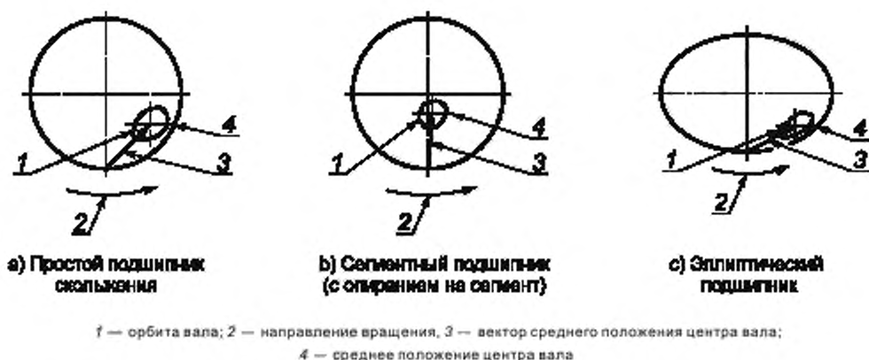
Рисунок С.5 — Типичные картины движения вала в гидродинамических подшипниках
