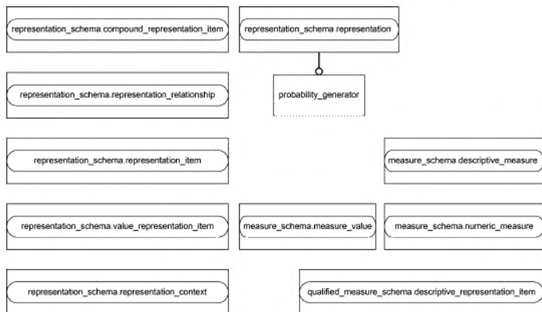
Рисунок D.2 — Представление ИММ на уровне объектов в формате EXPRESS-G (диаграмма 1 из 1)
