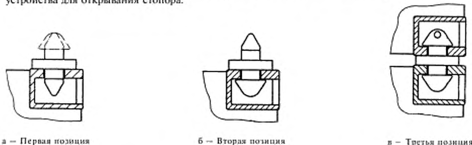
Рисунок А.3 — Полуавтоматический стопор, установленный в нижний угловой фитинг
