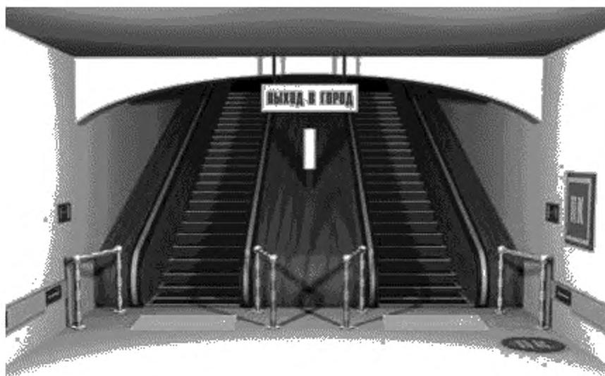
Рисунок Б.9 – Пример обозначения элементами ФЭС эскалатора метрополитена; вид при освещении
