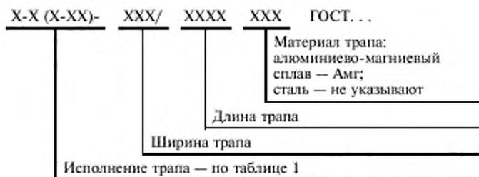
Пример условного обозначения вертикального трапа с однопрутковой ступенькой, исполнения 2-п, шириной 300 мм, длиной 600 мм, из алюминиево-магниевого сплава:
