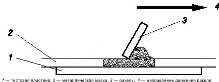
Рисунок 11 — Пример нанесения припойной пасты на тестовую пластину
