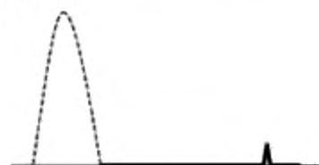
д) Смачивание отсутствует
