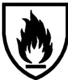
Рисунок 1 — Пример пиктограммы для защитной специальной одежды от высоких температур и огня (ИСО 7000-2417)
