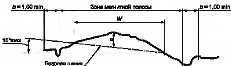
Рисунок 7 — Выпуклый профиль полосы
