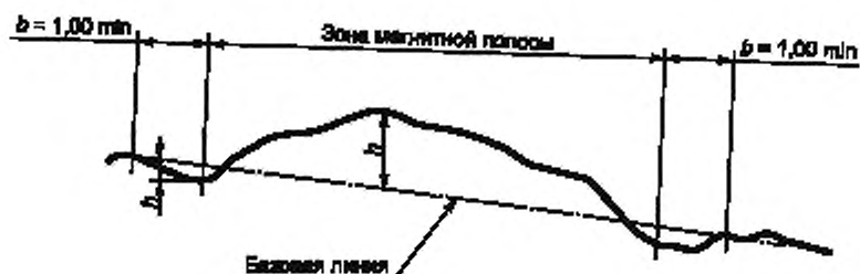
Рисунок 9 — Выпуклый профиль полосы
