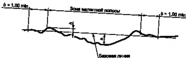
Рисунок 8 — Вогнутый профиль полосы
