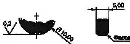
Рисунок 10 — Размеры контактной поверхности имитатора головки
