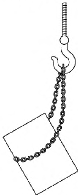
Рисунок 4 — Опасный и недопустимый способ подъема
