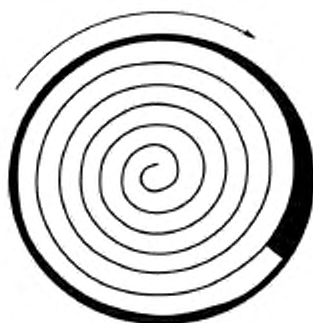
Рисунок 7 — Направление перекачивания рулона ленты
