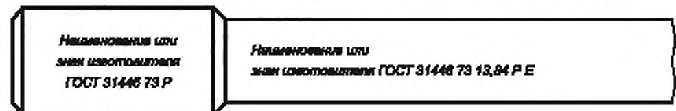
Маркировка клеймением муфты и трубы — необязательная (не менее чем в пределах 0,3 м от торца муфты)
