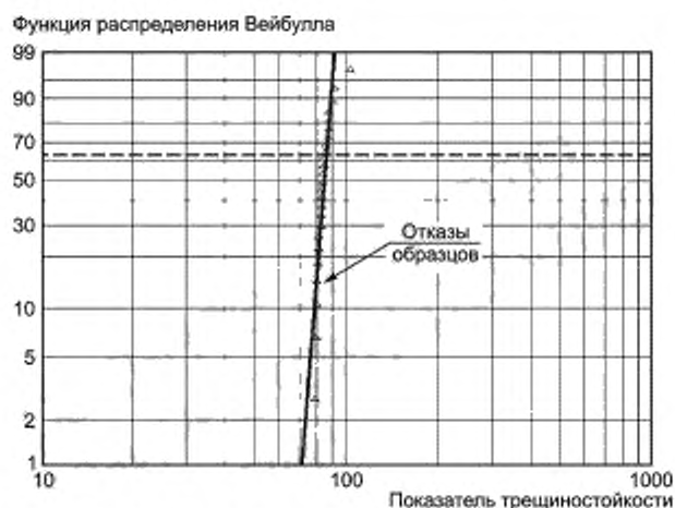
Рисунок Н.1 — Испытания на разрыв стальной пластины
