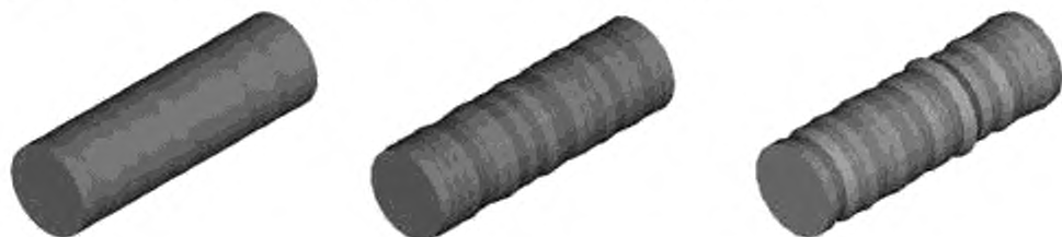
Рисунок X1.2 — Профили волокна, демонстрирующие изменчивость диаметров волокна по длине
