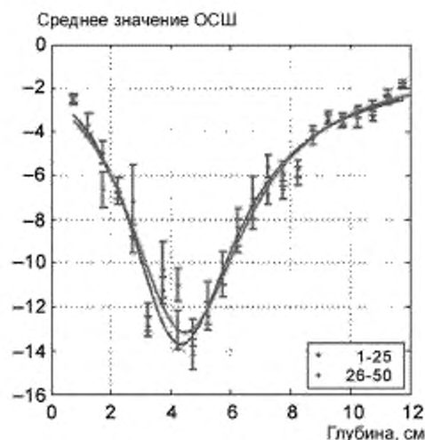
а Средние значения ОСШ (ОСШ с ) в зависимости от глубины в соответствии с двумя независимыми наборами из 25 изображений, относящиеся к рисункам В.1 и В.2
