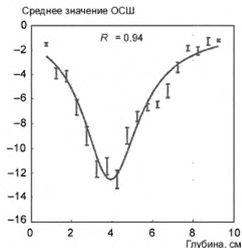
а Средние значения ОСШ (ОСШ с ) в зависимости от глубины для фантома в среднем с одной слабоотражающей сферой диаметром 3,2 мм на миллилитр
