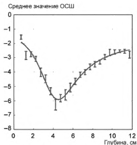
а Средние значения ОСШ (ОСШ с ) в зависимости от глубины для фантома в среднем с одной слабоотражающей сферой диаметром 4 мм на миллилитр
