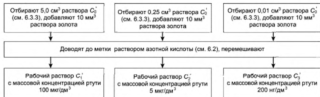
Рисунок 2 — Приготовление рабочих растворов C'_1, C'_2, C'_3
