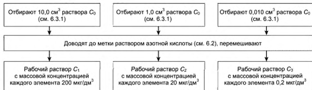
Рисунок 1 — Приготовление рабочих растворов C_1, C_2, C_3
