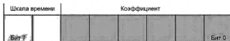
Рисунок В.2 — Минимальное время цикла MinCycleTime
