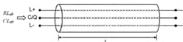
Рисунок 25 — Схема измерения эффективной емкости линии и сопротивления шлейфа
