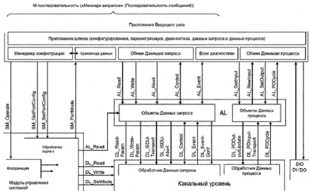
Рисунок 55 — Структура и услуги AL (Ведущий узел)
