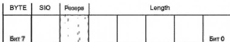
Рисунок В.5 — Параметр ProcessDataIn
