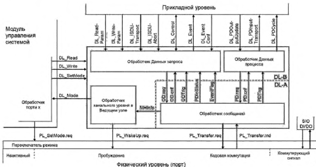
Рисунок 26 — Структура и услуги DL (Ведущий узел)
