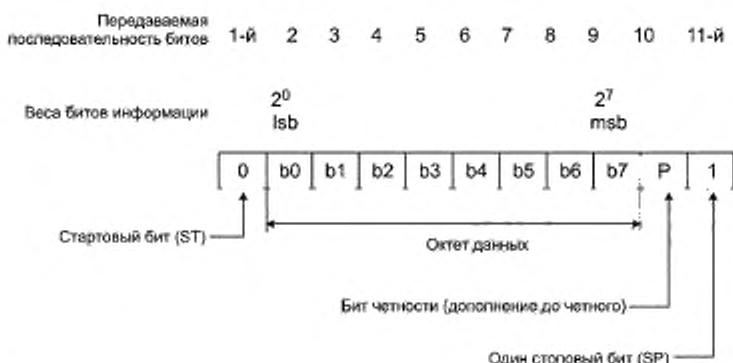
Рисунок 18 — Формат фрейма UART в технологии SDCI
