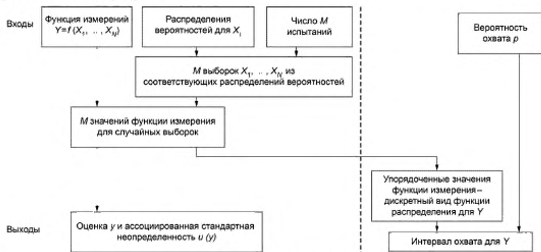
Рисунок 8 — Оценивание неопределенности методом Монте-Карло (левая часть рисунка, выделенная пунктирной линией, относится к получению значения оценки u и ассоциированной с ней стандартной неопределенности u(y) , остальная — к получению интервала охвата для Y )
