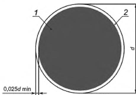
$d$  — диаметр круга; 1 — основная поверхность; 2 — кант
