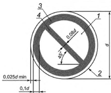
$d$  – диаметр круга; 1 – основная поверхность; 2 – кант; 3 – жайма; 4 – поперечная полоса
