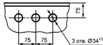
Рисунок 5 — Расположение и размеры отверстий в полочках умывальников для установки смесителей: для центрального смесителя (а) и для смесителя с нижней камерой смешения (б)
