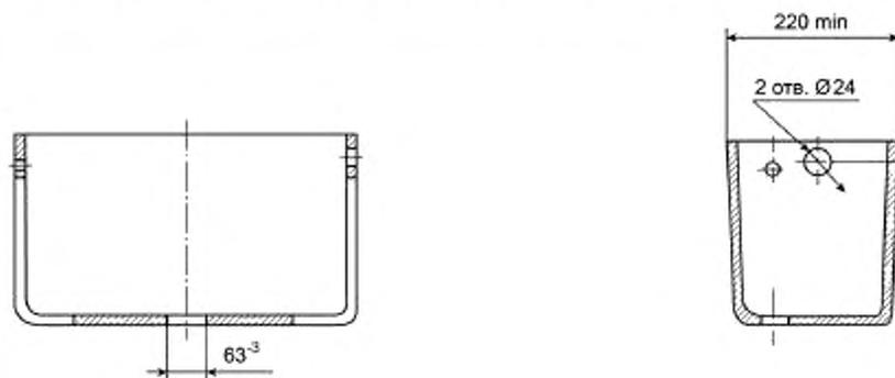
Рисунок 9 — Смывной высокорасполагаемый бачок с боковым пуском
