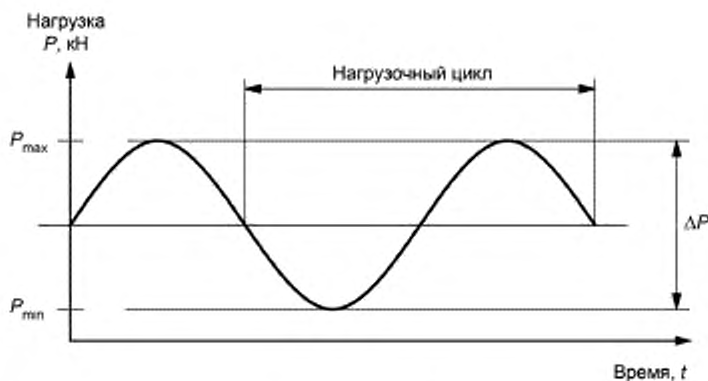
Рисунок 4 — Характеристика цикла нагрузки при испытаниях на выносливость
