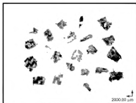
б — образцы измельченных полимерных композитов, армированных тканым углеродным наполнителем
