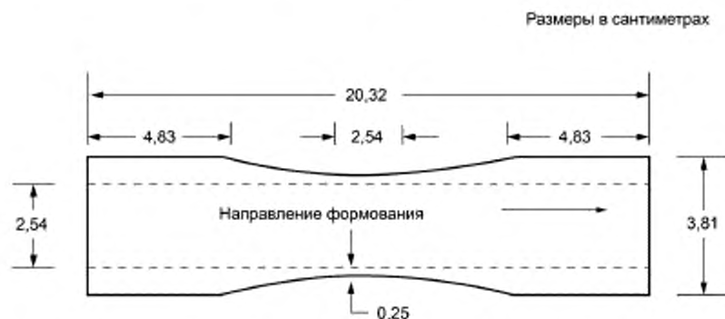
Рисунок В.3 — Образец с прямыми захватными участками (образец с формируемыми захватными участками)
