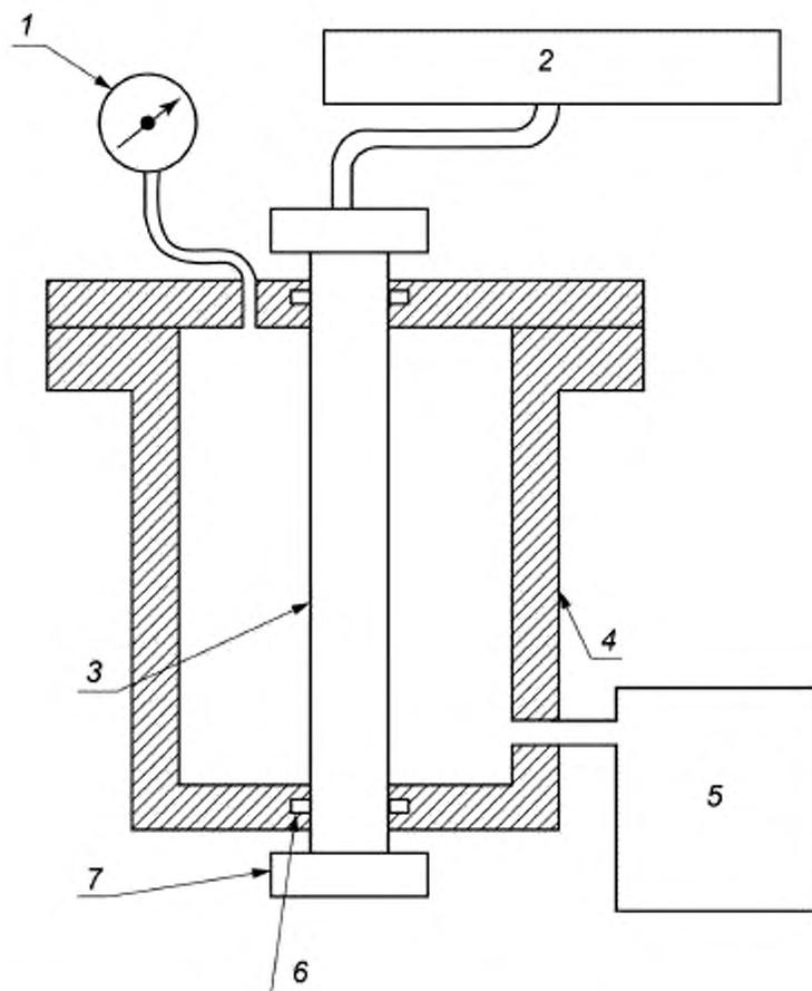
1 — манометр с трубкой Бурдона; 2 — емкость; 3 — образец; 4 — камера; 5 — источник давления;
