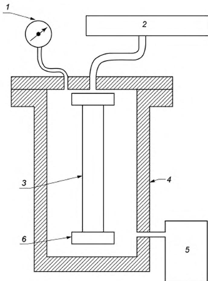
1 — манометр с трубкой Бурдона; 2 — емкость; 3 — образец; 4 — камера; 5 — источник давления,
