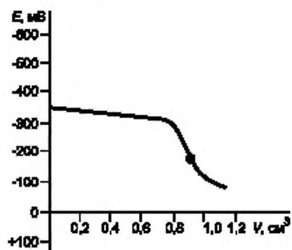
Рисунок А.4 — Кривая потенциометрического титрования серооксида углерода раствором азотнокислого аммиака серебра
