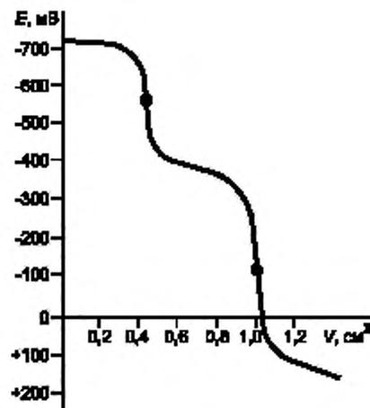
Рисунок А.3 — Кривая потенциметрического титрования сульфид- и меркаптид-ионов раствором азотнокислого аммиаката серебра
