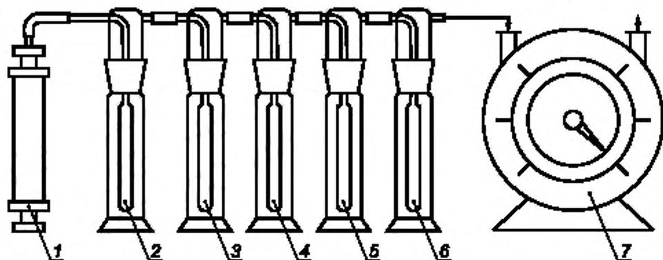
1 — пробоборник; 2 — предохранительная склянка; 3—6 — поглотительные склянки, 7 — газовый счетчик
