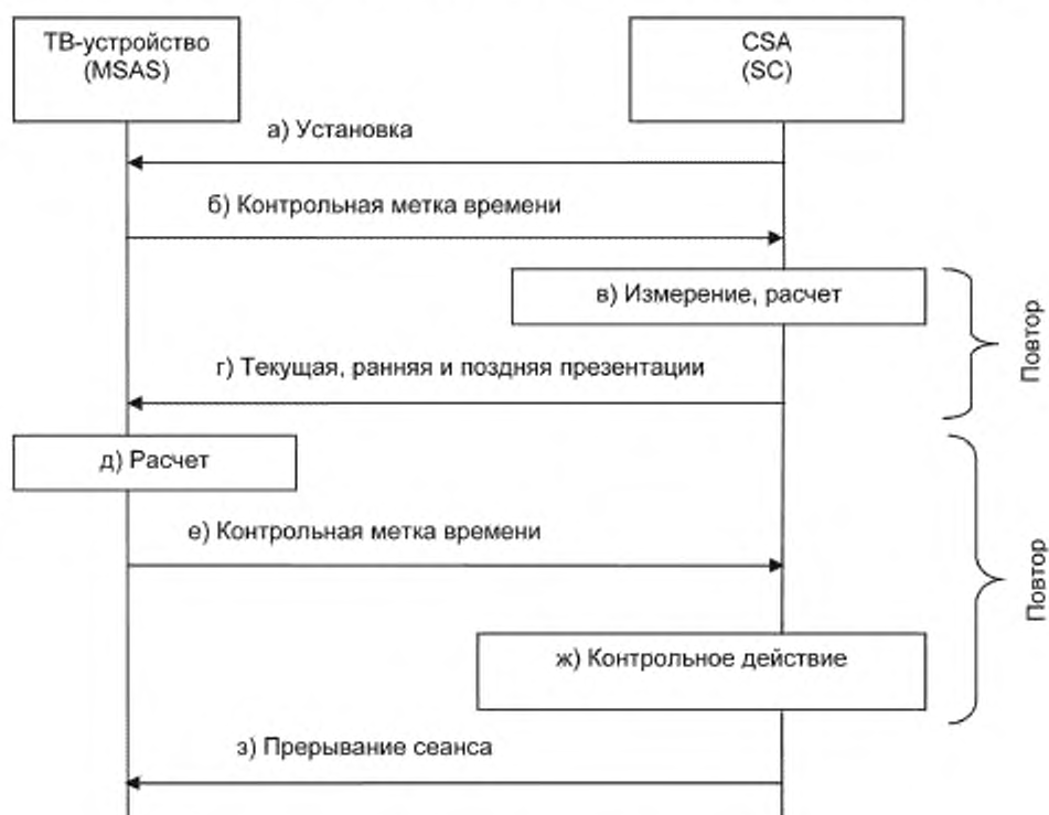
Рисунок 9 — Процедура синхронизации временной шкалы через интерфейс TLS
