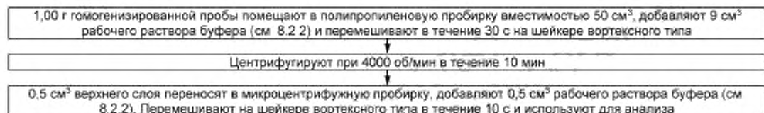
Рисунок 6 — Подготовка проб мяса для тест-системы № 1 и тест-системы № 2
