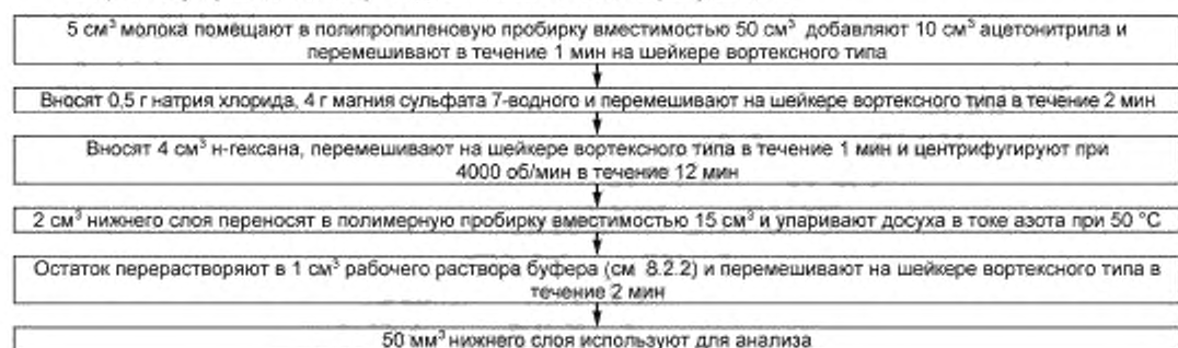
Рисунок 5 — Подготовка проб молока для тест-системы № 7
