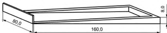
Рисунок 1 — Форма-рамка для изготовления образцов при определении стойкости к образованию усадочных трещин
