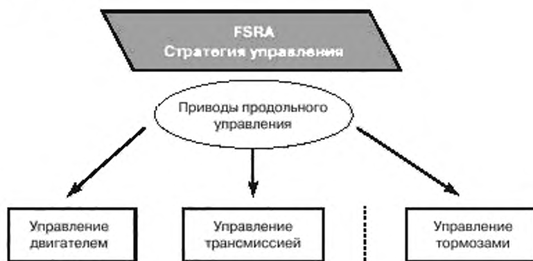
Рисунок 10 — Приводы продольного управления
