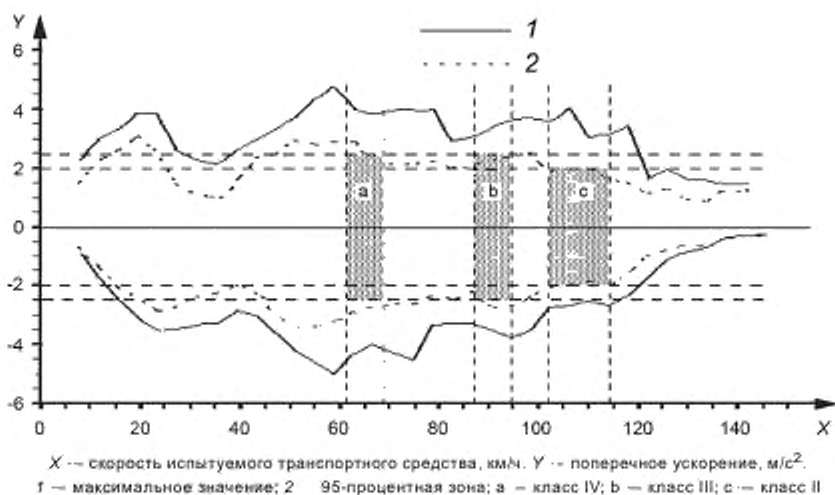
Рисунок 6 — Поперечное ускорение для среднего водителя
