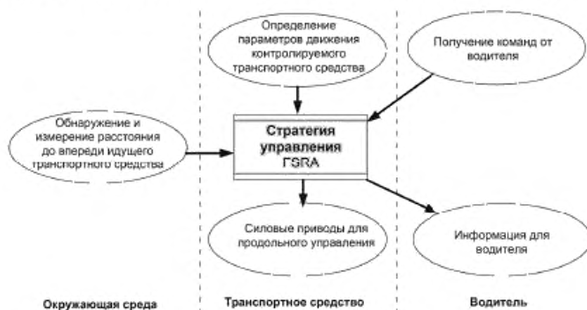
Рисунок 1 — Функциональные элементы FSRA
